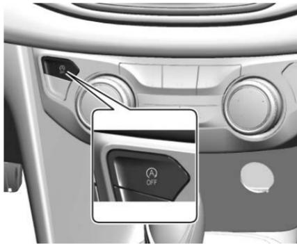
Si está equipado, la característica de paro/arranque automático de motor se puede desactivar y activar presionando el interruptor con el símbolo **(A)**. El Paro automático se activa cada vez que arranca el vehículo.
