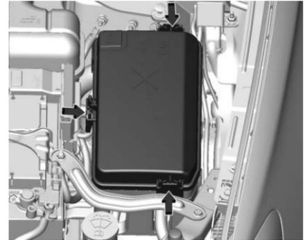
Para retirar la cubierta del bloque de fusibles, presione los seguros y gírela hacia arriba.
