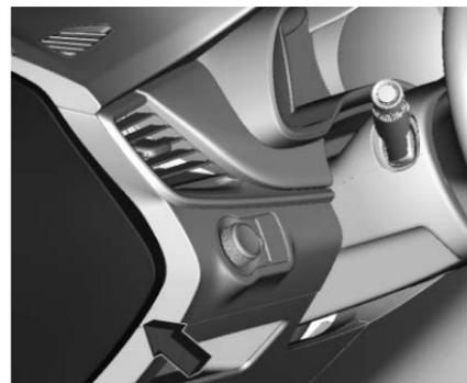
Retire la cubierta y reemplace el fusible.
