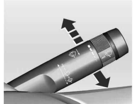
La palanca del limpiaparabrisas/lavador está en el costado de la columna de dirección. Con la ignición encendida o en ACC/ACCESSORY (accesorios), mueva la palanca del limpiaparabrisas para seleccionar la velocidad del limpiaparabrisas.
