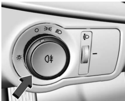
El control de la luz exterior está en el tablero de instrumentos al lado exterior de la columna de dirección.
