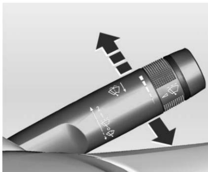
La palanca del limpiaparabrisas/lavador está en el costado de la columna de dirección. Con la ignición encendida o en ACC/ACCESSORY (accesorios), mueva la palanca del limpiaparabrisas para seleccionar la velocidad del limpiador.
