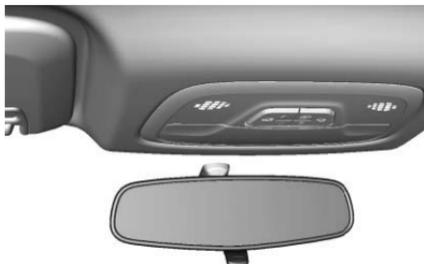
Para reducir el brillo de los faros que vienen detrás, ajuste la palanca en el botón de la carcasa del espejo.
